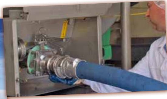
Lors du transport et déchargement du chocolat liquide, la température doit être maintenue à 50°C.
