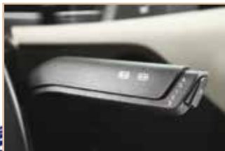
Le chauffeur actionne le retardateur au moyen d'une petite manette au volant.
